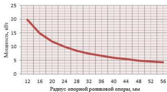
Рис. 4. Изменение разницы максимума и минимума потребляемой мощности в зависимости от конструктивных параметров роликовой опоры
