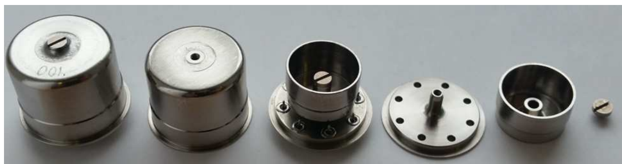
Рис. 5. ВТГ-ДУС с металлическим резонатором; слева - направо прибор в сборе, кожух, чувствительный элемент (резонатор на основании), основание с узлом крепления, резонатор, крепежный винт
