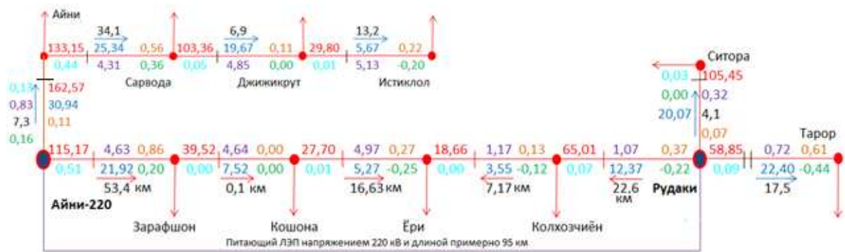
Рис. 5. Модель электрической питающей сети с двухсторонним питанием
