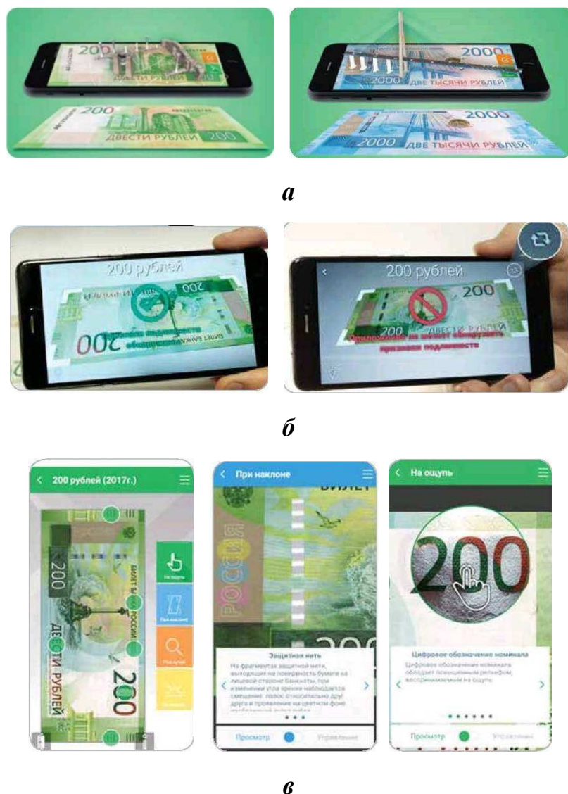
Рис. 5. Принцип работы мобильного приложения «Банкноты 2017»: а – распознавание; б – проверка подлинности; в – информация о защитном комплексе банкноты
