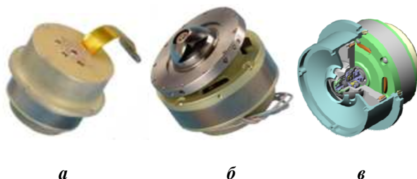
Рис. 1. ИУП-01: а – прибор в сборе; б – прибор со снятым кожухом; в – 3D-модель
