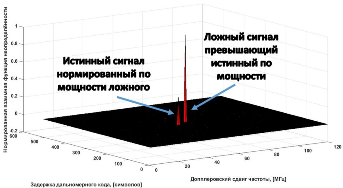
Рис. 4. Истинный и ложный сигнал в пространстве поиска по частоте и задержке
