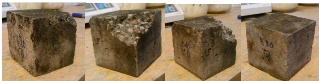
Рис. 2. Образцы бетона после испытания импульсной нагрузкой взрыва зарядов ВВ
