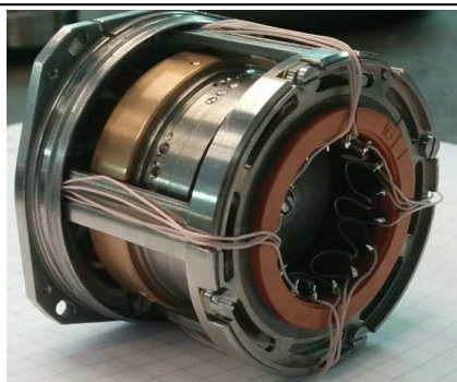
Рис. 4. Модернизированный гироскоп Д7-М (без платы электронной)
